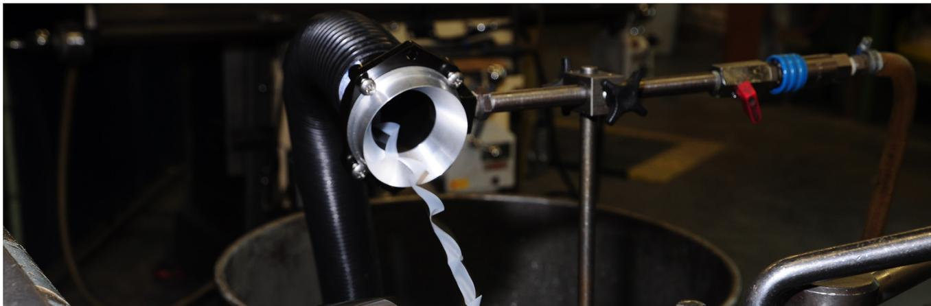
Il existe plusieurs modèles de Transvecteurs d'un diamètre intérieur allant de 10 à 127 mm. Deux matériaux de construction ont été retenus pour la fabrication des Transvecteurs : alliage aluminium/magnésium ou bien acier inoxydable.
