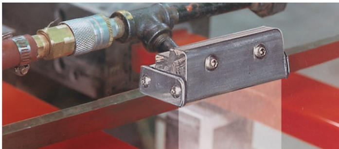
Le coefficient d'amplification d'un Transvector à rideau d'air est de 25 et le débit total restitué peut atteindre 90 m<sup>3</sup>/mn. Le débit total entraîné peut être contrôlé par un régulateur de débit qui équipe en série les ensembles complets 961-3, 961-6, 961-12, 961-18 et 961-24.
