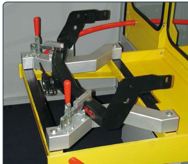
Modèle 247-U retenant un châssis métallique
