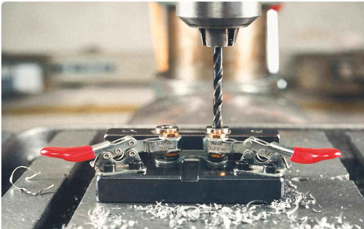
*Modèle 205-U sur un outillage de perçage*
