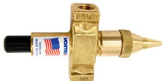
Les Sprayvectors utilisent le principe de l'amplification de débit d'air et, puisqu'ils sont également raccordés côté liquides, permettent de produire de très fines gouttelettes de 20 à 120  $\mu$ . On oblige l'air comprimé à entrer dans la buse par une chambre annulaire dont l'issue est une fine fente de 0.05 mm d'épaisseur.
