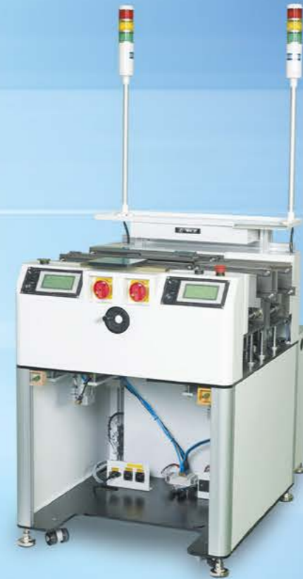
SPI NG CONVEYOR
