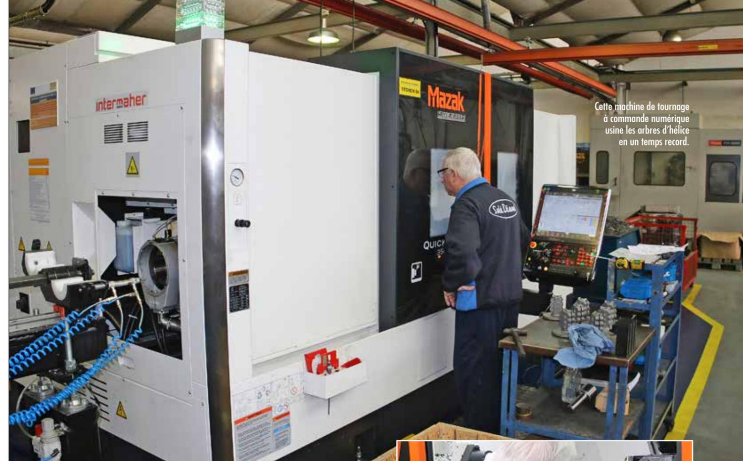
Cette machine de tournage à commande numérique usine les arbres d'hélice en un temps record.
