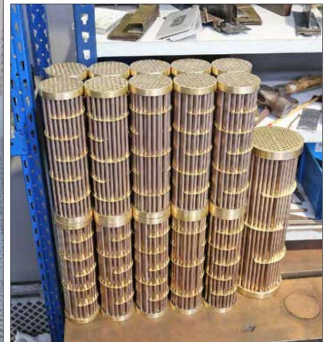
L'usine construit aussi cet assemblage de tubes en cupronickel, qui se placent à l'intérieur de l'échangeur de chaleur servant à refroidir l'huile du moteur.
