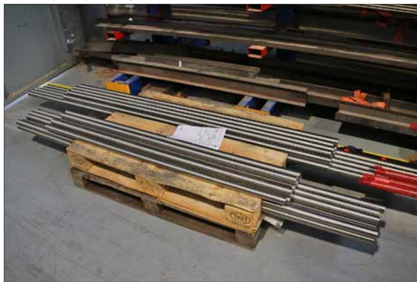
Un des métiers de Solé Diesel est l'usinage d'arbres d'hélice en inox mesurant jusqu'à 100 mm de diamètre.
