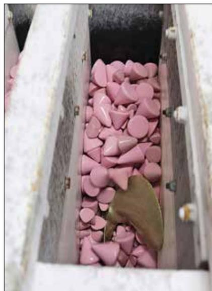
Les hélices sont plongées 3 heures dans un bain de cônes abrasifs dans une machine vibrante et ressortent polies.
