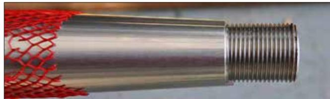
Après usinage, l'arbre d'hélice conique ressort avec un filetage parfait pour accueillir la future hélice.
