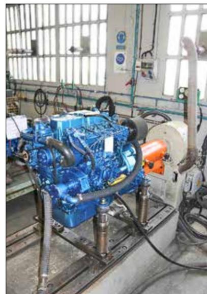
Ce 4 cylindres atmosphérique de 65 chevaux est testé sur le banc de puissance.
